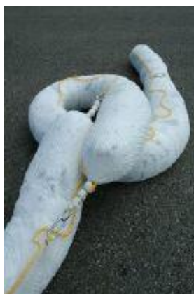
Photo 9 : Sorbent boom (source Cedre)
